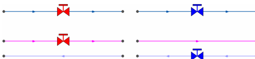
Рисунок 2.33. Сверху: однолинейное изображение сети, снизу – внутренне представление
