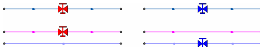
Рисунок 2.32. Сверху: однолинейное изображение сети, снизу – внутренне представление
