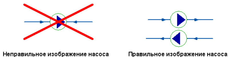
Рисунок 2.19. Неправильное и правильное изображение насоса
